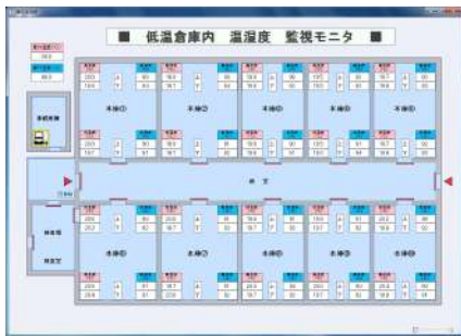
温湿度監視グラフィックモニター
